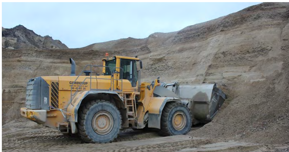
Figur 4.6: Indvindingen sker oftest med en frontlæsser fra foden af gravefronten.
