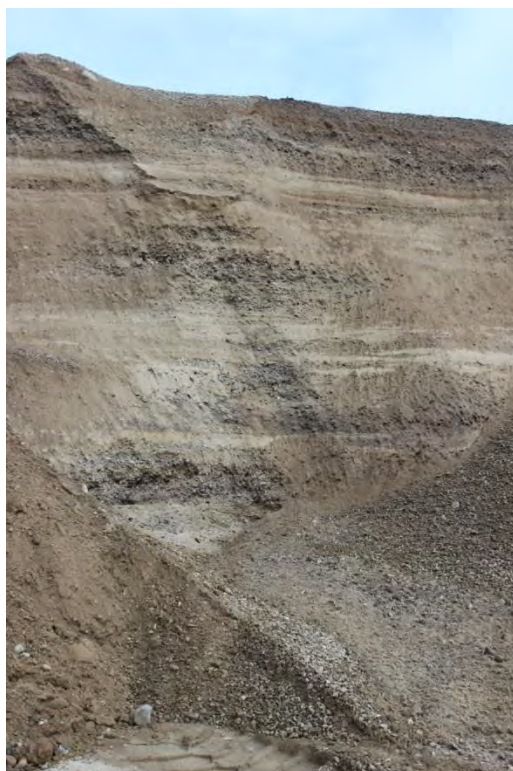
Figur 1.3: Profil fra den nordøstlige del af råstofgraven på matr. nr. 1ar Kjellerup Hgd., Svenstrup, hvor materialerne er relativt finkornede. Profilet er ca. 5 meter højt.
