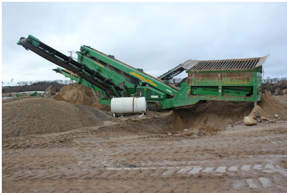
Figur 3.6: Mobilt tørsorteringsanlæg, med en forsigte og dieseltank til brændstofforsyning.
