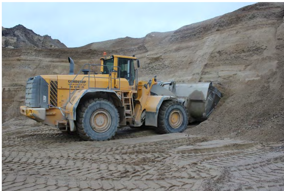
Figur 3.5: Indvindingen sker oftest med en frontlæsser fra foden af gravefronten.
