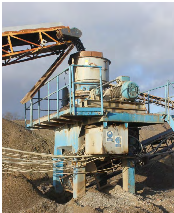
Figur 4.12: Forknuser som anvendes i produktionslinjen til stabilgrus.
