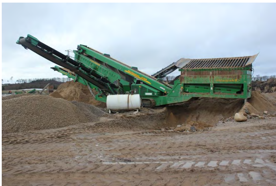
Figur 4.7: Mobilt tørsorteringsanlæg, med en forsigte og dieseltank til brændstofforsyning.
