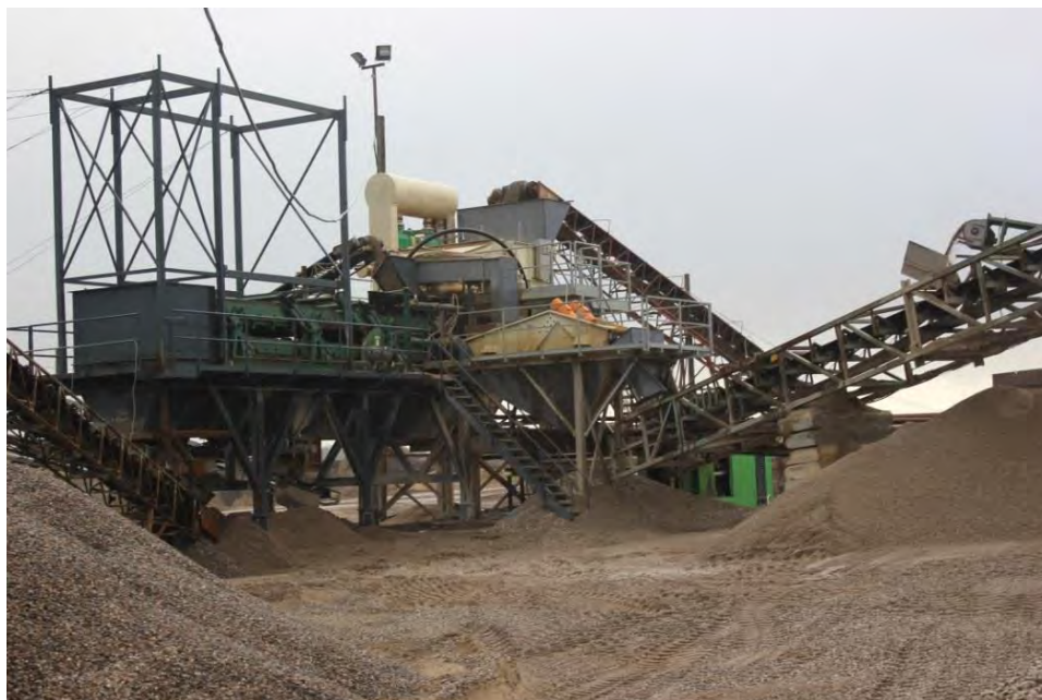
Figur 3.8: Densitetssorteren, jiggjen, der ved vibrationer sorterer materialet efter vægt. Densitetssorteren er en del af anlægget til produktion af betontilslag.
