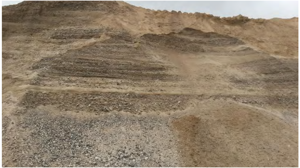
Figur 1.4: Profil fra den vestligste del af grusgraven på matr. nr. 1ar Kjellerup Hgd., Svens- trup, hvor der ses mange gruslag og forekomsten generelt er relativt grovkornet. Profilen er ca. 5 meter høj.
