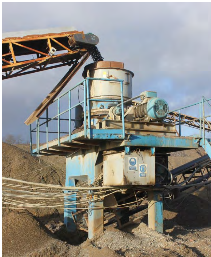
Figur 3.11: Forknuser som anvendes i produktionslinjen til stabilgrus.
