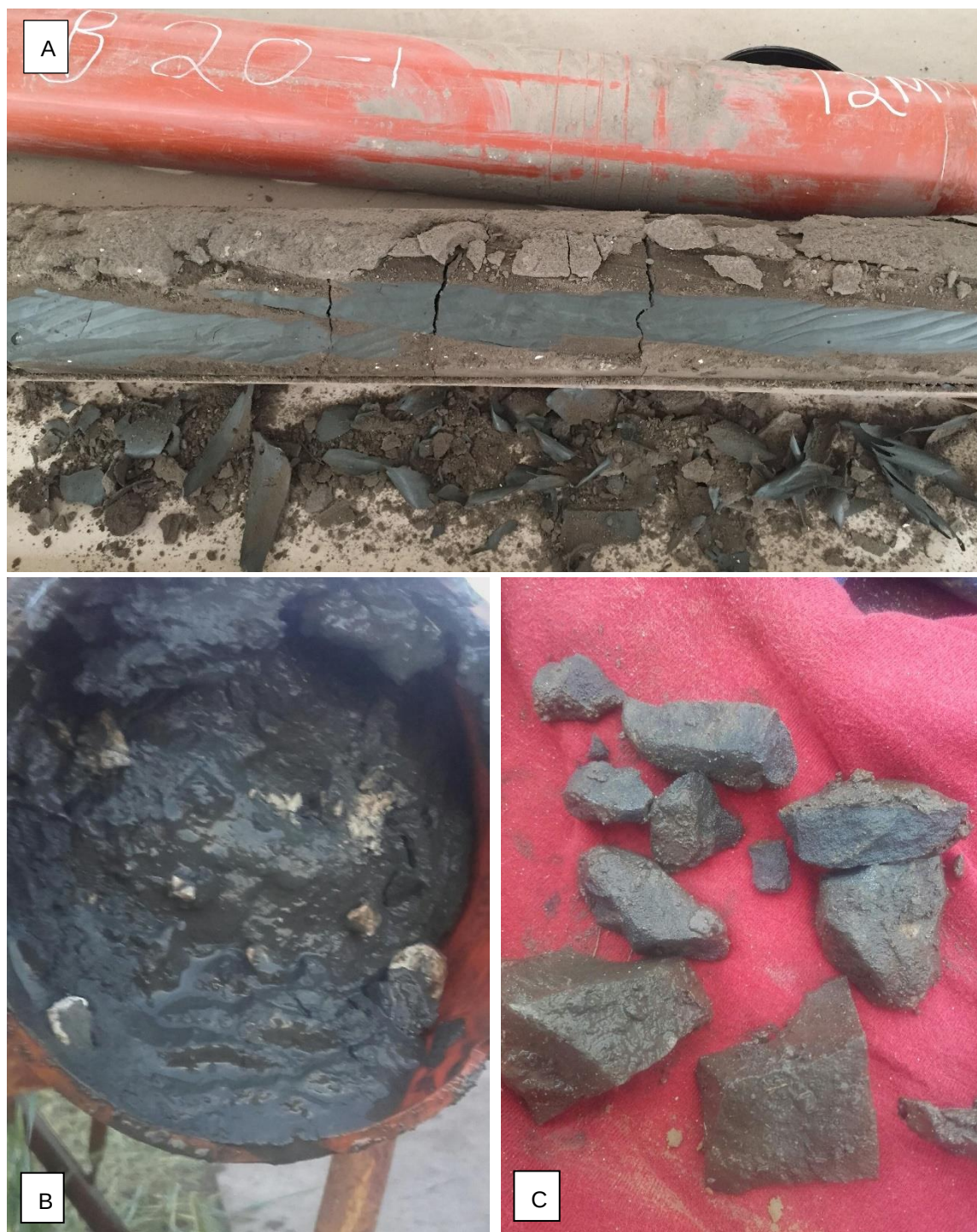
Figur 4.2. A: Plastisk ler fra B20-1, 11-12 meter under terræn Foto: Jens Demant Bernth. B: Kalkstykker i våd, sort moler fra B22, 15 meter under terræn Foto: PC Brøndboring. C: Cementsten fra B24, ca. 10 meter under terræn Foto: PC Brøndboring.
