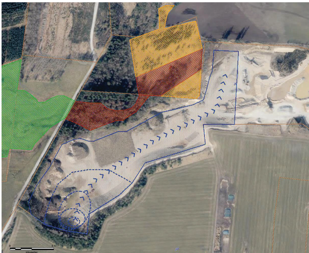
Figur 1.1: Graveplan, der med blå stiplede linjer illustrerer udbygning af gravesøen, den maksimale udbredelse af gravesøen med blå linje samt graveretning med blå pile.
