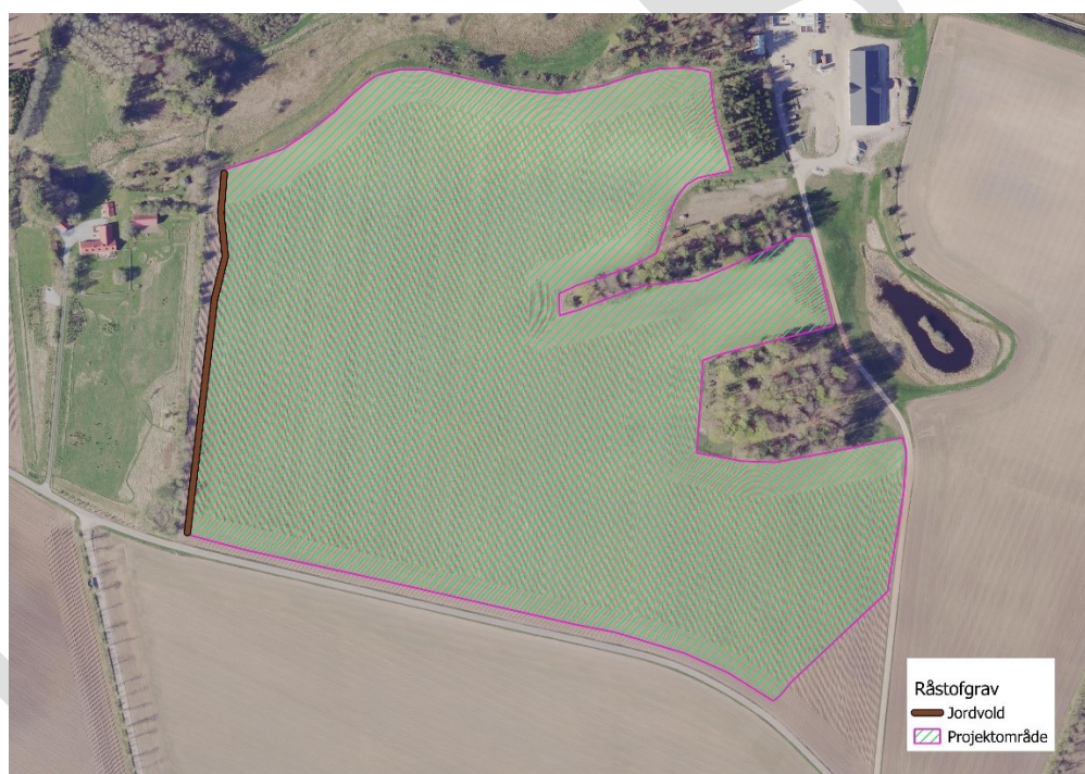
Figur 1: Der skal etableres en jordvold op mod nabo langs det vestlige skel
