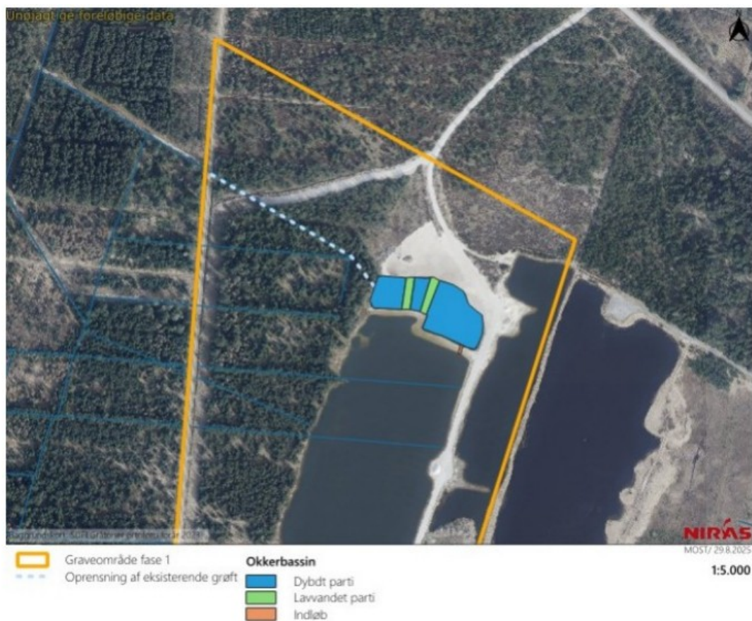
Figur 2: Der er ansøgt om at etablere et okkerudfældningsbassin, hvor vand fra råstofgraven vil blive ledt i gennem. Bassinet etableres i den nordlige del af råstofgraven.
