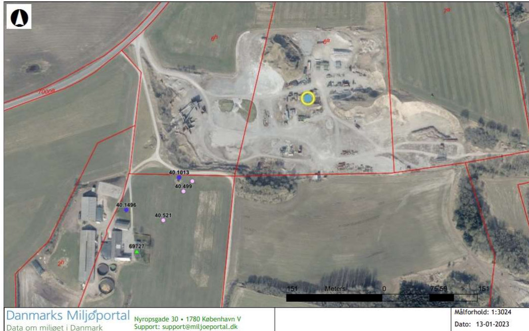
Figur 5: Boringer i nærheden af grusgraven. Blå cirkel = Vandboring, Lyserød cirkel = Sløjet boring. Grøn trekant = Vandforsyningsanlæg erhverv
