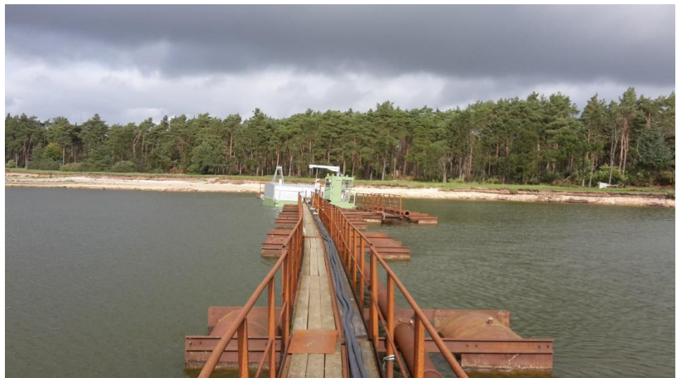
Figur 4.3: Suger, der anvendes til indvinding under grundvandsspejlet.
