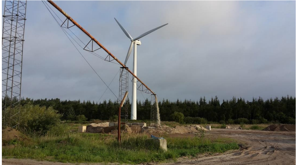
Figur 4.7: Fint sand og vand, som via et rør sendes fra sorteranlæg direkte tilbage til kanten af søen, hvor det indgår i efterbehandlingen.
