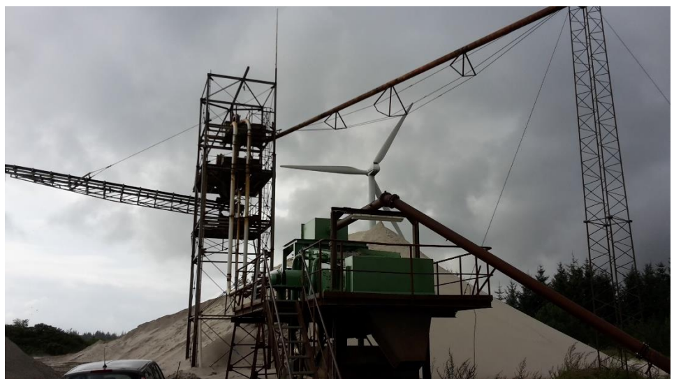
Figur 4.6: Sorterianlæg der fjerner vand og tørv fra råstoffet.
