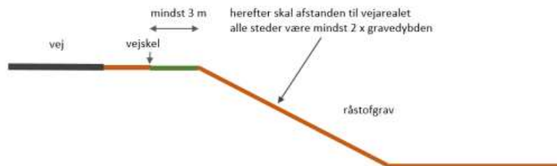
Figur 1. Princip for afgravning ud mod Skarrehagevej.
