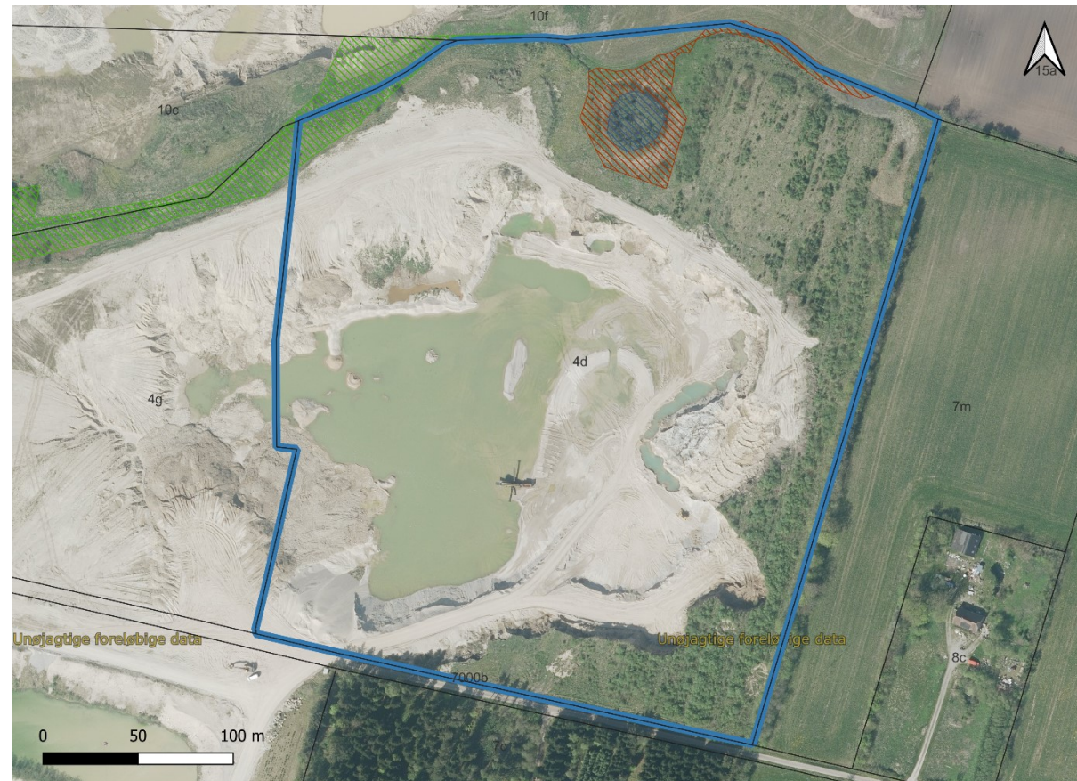
Figur 1 - Luftfoto fra foråret 2024, hvor det fremgår at der er gravet under grundvandsspejlet på ca. 2 ha på matr.nr. 4d True By, Vebbestrup. Omfanget af råstoffilladelsen af den 25.november 2019 er markeret med blå. På kortet fremgår også arealer der er registreret som beskyttet natur iht. naturbeskyttelseslovens § 3; Mose = rød skravering, Sø = blå skravering, Fersk eng = grøn skravering.
