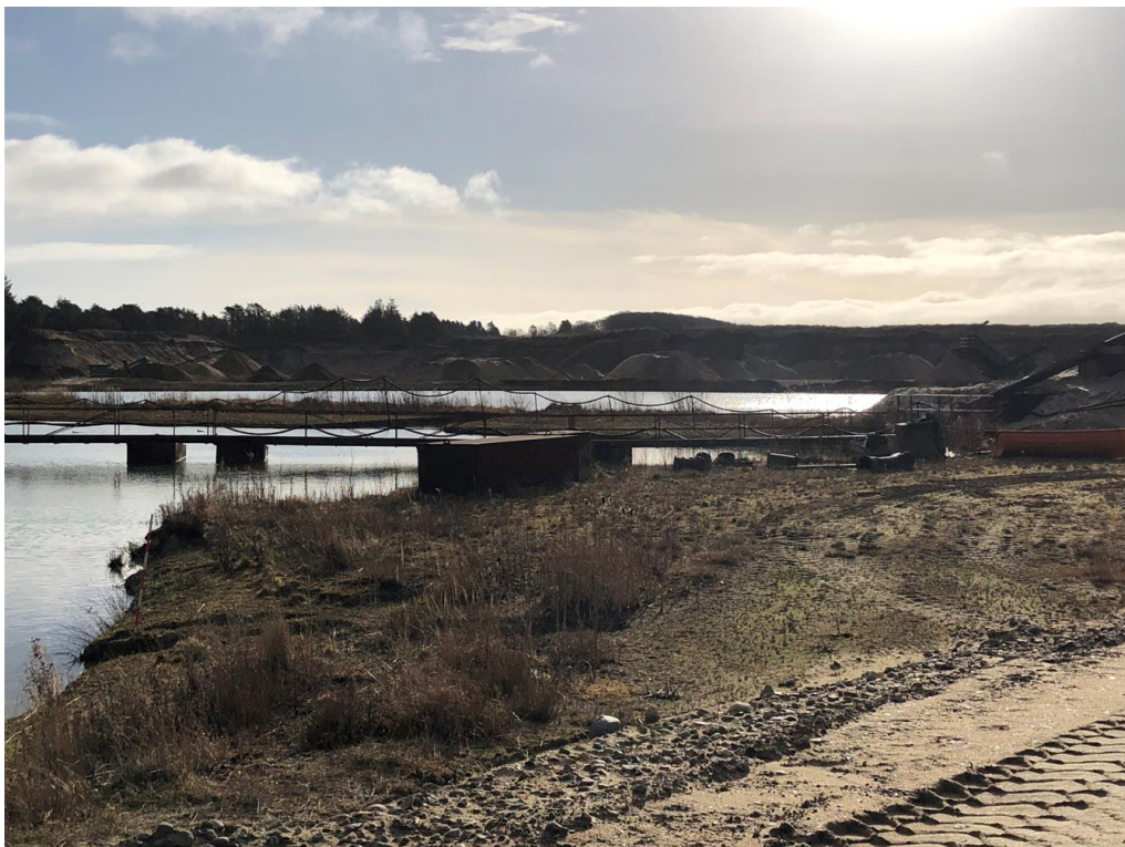
Figur 3-13 Sugepram med suger placeret forrest og bagest rørledning til at transportere materialerne ind på land.
