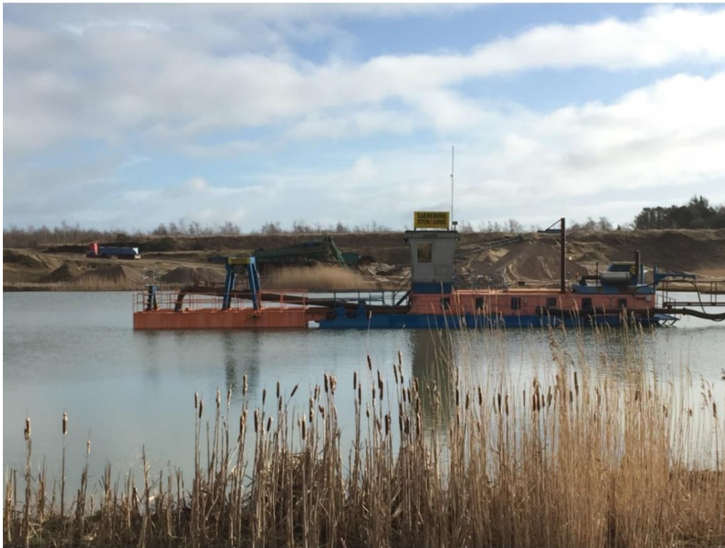
Figur 3-13 Sugepram med suger placeret forrest og bagest rørledning til at transportere materialerne ind på land.
