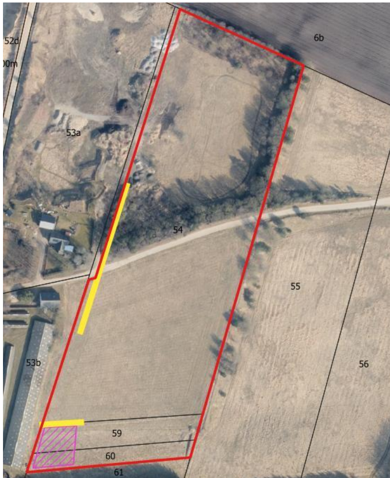
Figur 1: Placering af støjvolde (gule steger), og område for placering af sorteringsanlæg indtil den nordlige støjvold er etableret (lilla skravering).
