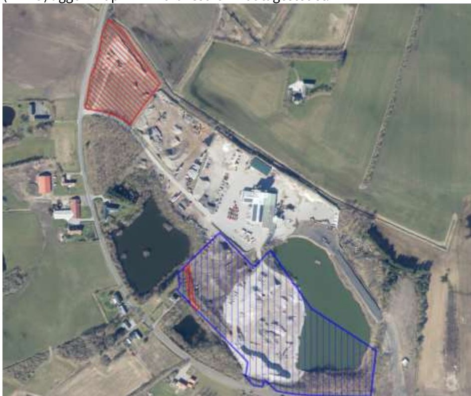
Figur 1: Blå skravering viser det tilladte indvindingsareal jf. indvindingstilladelse af 14. september 2021. Med rød skravering ses dels placeringen af den planlagte støjvold indenfor det tilladte indvindingsareal samt opgravningsstedet på den nordvestlige del af ejendommen.
