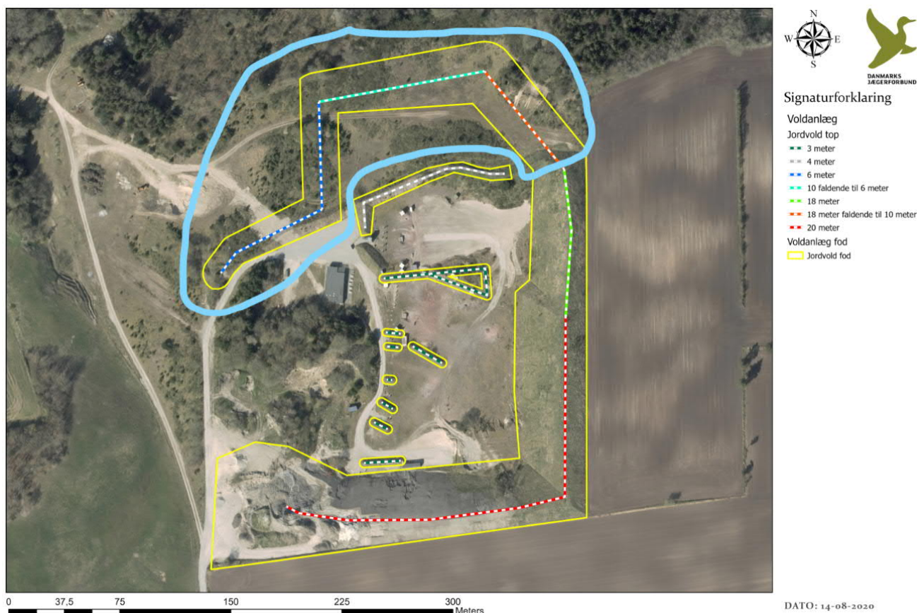
Figur 1: Placering og højde af det samlede voldanlæg. Blåt område omfatter planlagte volde, mens de øvrige volde allerede er etableret.
