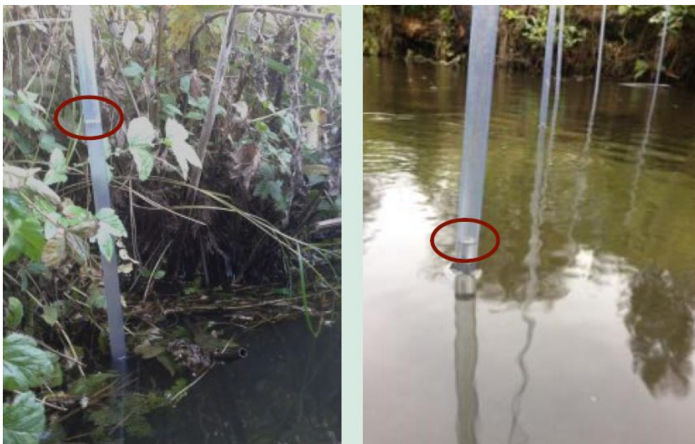
Figur 2 Piezometer af klar PVC. Der ses opadrettet gradient i rørene, dvs. indstrømning af grundvandet til vandløbet.
