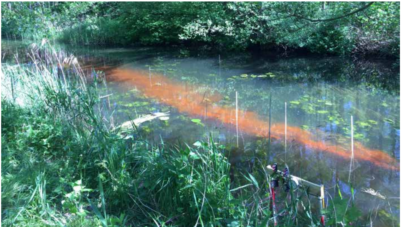
Sporstofforsøg i Mølleåen ved Raadvad. Forsøget viser, hvordan en jordforurening via grundvandet kan påvirke åen. Når forureningen er trængt ud i åen, vil den fortyndes og spredes med det strømmende vand.
