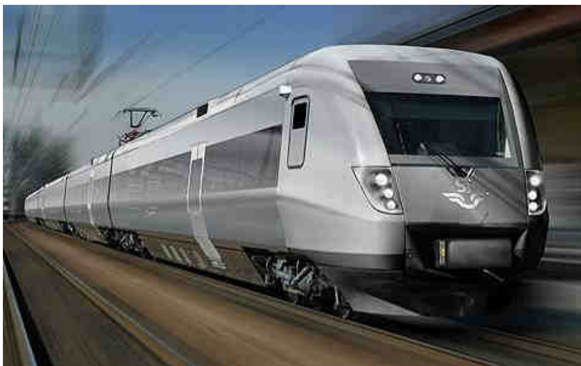
Fig. 5.2 Tyve af disse Regina-togsæt fra Bombardier leveres i 2010 til SJ's fjerntrafik i Sverige. Maksimalhastigheden er 200 km/t, men vil formentlig kunne øges til 250 km/t når erfaringerne fra projekt "Gröna Tåget" er indhøstet. Prisen for 20 togsæt med fire vogndele og ca. 240 siddepladser er iflg. pressemeddelelse fra Bombardier oplyst til i alt 221 mio. Euro i 2008.
