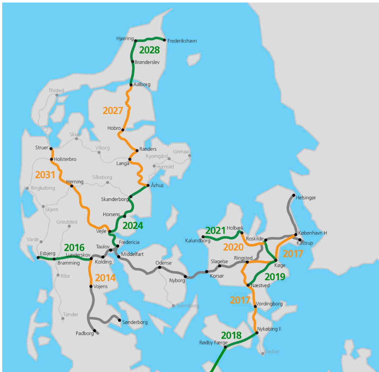
Fig. 3.2 En muligt model for elektrificering af de resterende hovedstrækninger i Danmark. Årstal markerer forventede tidspunkt for ibrugtagning af el-drift, såfremt Sjælland gøres færdig først.
