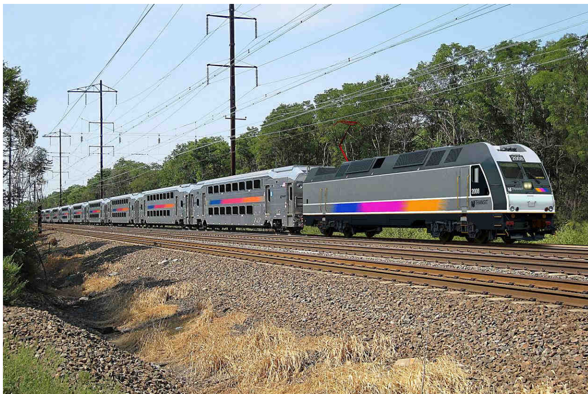
Fig. 5.4 I alt 46 hybridlokomotiver af typen ALP-46DP skal Bombardier levere til det amerikanske marked. Ved el-drift yder lokomotivet 4 MW og har en maksimal hastighed på 200 km/t henholdsvis 2,5 MW med maksimal hastighed på 160 km/t ved dieseldrift. Toget vil kunne udstyres med moderne intercity vogne i Danmark, og anvendes som fjerntog på såvel el. som dieselstrækninger.
