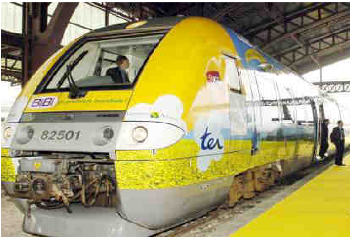
Fig. 5.1 Franskbygget AGC-togsæt fra Bombardier fra 2005, der enten kører som diesel-elektrisk togsæt eller som ren elektrisk togsæt.
