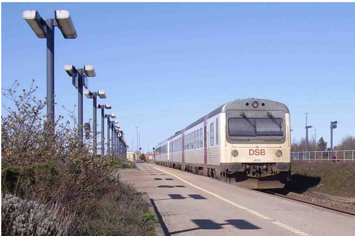
Fig.4.1 To MR-togsæt afgår fra Frederikshavn. Denne type anvendes i de fleste regionaltog i Nordjylland, herunder Aalborg Nærbane. MR-togene blev bygget i 1978-86, og har en gennemsnitsalder på 27 år. Levetiden for dieseltog af denne type skønnes til ca. 30-35 år.
