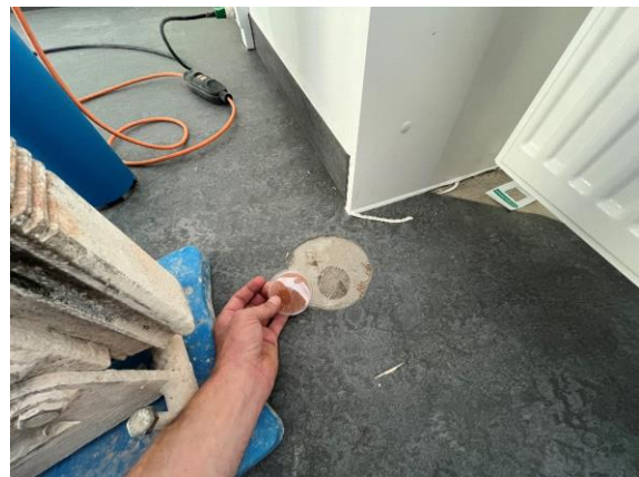
#4 Prøver A er udtaget fra underside af banevare på slidlag 40 cm fra vindue. Tilsvarende er prøver E udtaget under banevare, blot 240 cm fra vindue.
