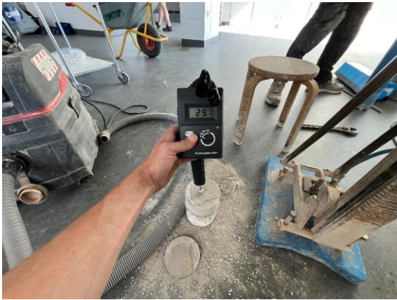
#7 Prøvetagning 240 cm fra lysning. Prøve B er udtaget fra slidlag til veje-tørre-veje analyse samt RF-måling.
