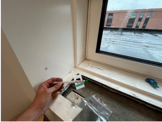
#13 Der er prøvetaget for skimmel under aluminiumslysning og under pap.
