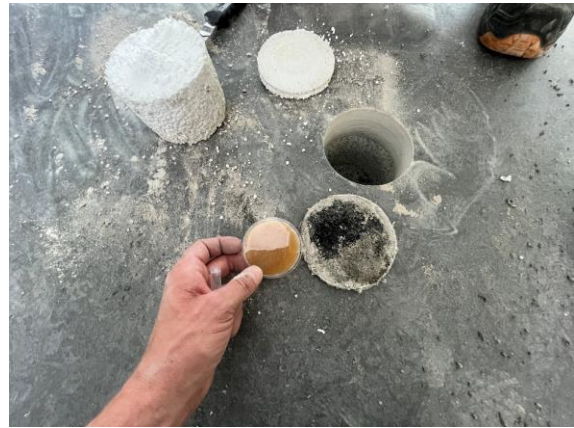
#8 Prøver G og H er udtaget til laboratorieanalyse fra åbningen.
